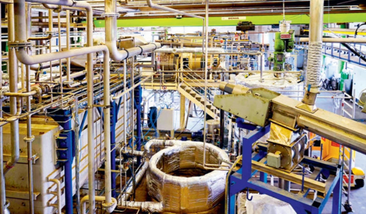
Die Anlage in Memmingen, mit der täglich zehn Tonnen Industrieabfälle aus der PE/PA-Verbundfolien-Produktion wieder sortenrein voneinander getrennt werden
