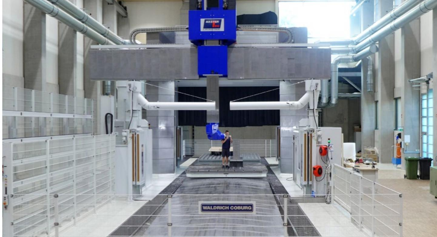
**Ein Gigant der Genauigkeit:** Die „MasterTec 5500 AT“ ist eine eigens für GERG konstruierte Fräsmaschine – entwickelt vom Maschinenbauer Waldrich Coburg. Sie bearbeitet Bauteile bis 14 Meter Länge mit einer Präzision von 0,02 Millimetern
